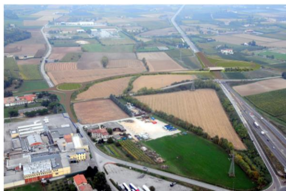
Collegamento viabilità basso Garda alla S.R. 450: tracciato di progetto e foto simulazione
