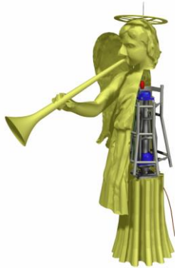
Statua dell'angelo della Basilica del Santo: spaccato virtuale e assemblaggio in officina della nuova struttura di sostegno
